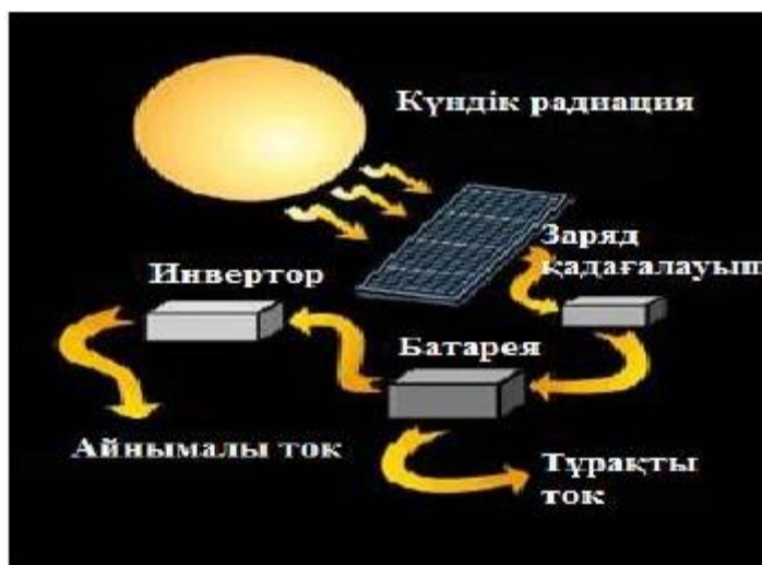
17 – сурет. Күн батареясының күн радиациясымен сәйкестенуі
