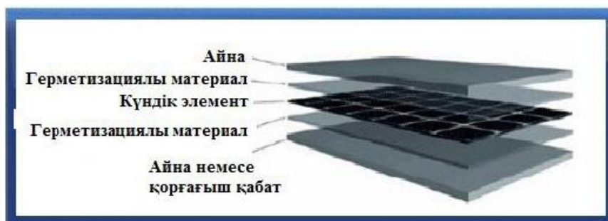
2 – сурет. Күн панелінің құрылысы
